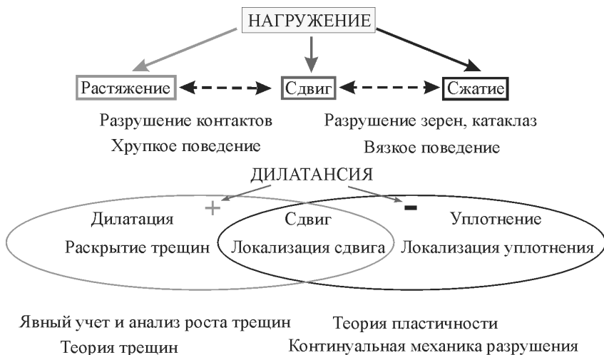
Рис. 1. Схема явлений наблюдаемых в плотных и высокопористых геологических средах при различных условиях нагружения
